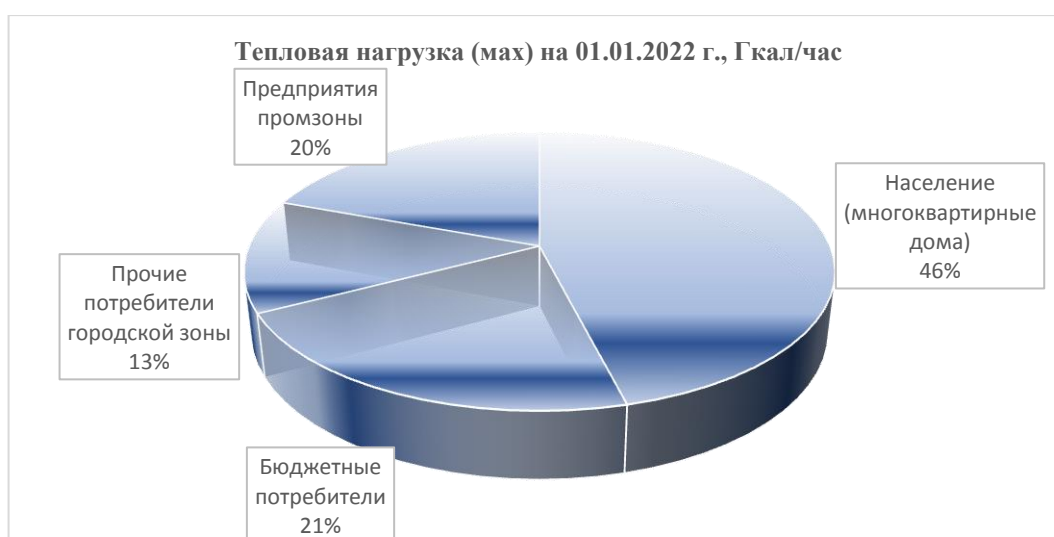
Рисунок 5 Тепловые (мах) нагрузки в разрезе категорий потребителей
